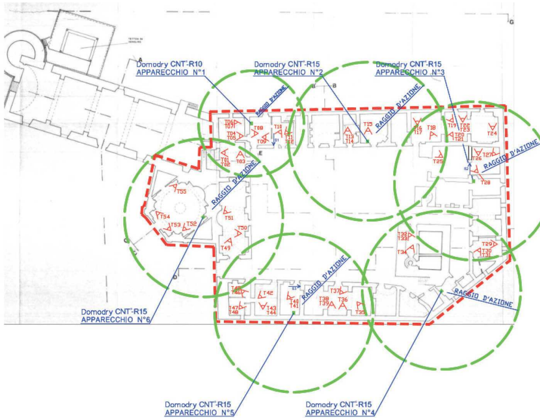
Fig.3 – Castello di S. Basilio: schema planimetrico impianto CNT
