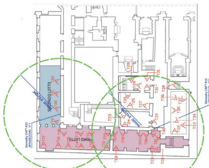
Fig.17 – Museo Diocesano di Matera: schema planimetrico impianto CNT
