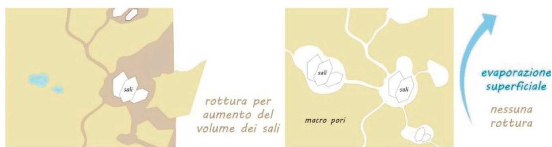
Figura 5. Micro-struttura degli intonaci macroporosi
