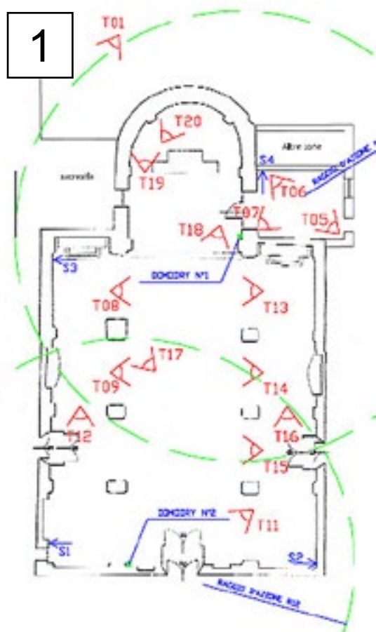
Fig. 5 - Schema dell'impianto Domodry (1) con posizionamento in pianta degli apparecchi (2) e (3) e delle prove effettuate (termografie all'infrarosso –cfr. Figg.6÷9)
